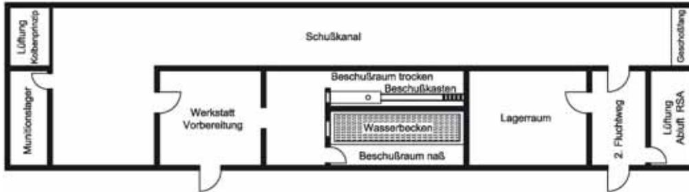
Abbildung 5.6.3.7.1 Beispielhafte Anordnung von Prüf- und Messräumen
