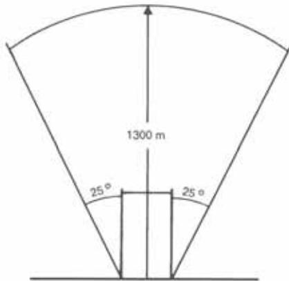
Abbildung 4.2.1 Beispiel für den Gefahrenbereich der Geschosse von Randfeuerpatronen im Kaliber .22 l.r.
