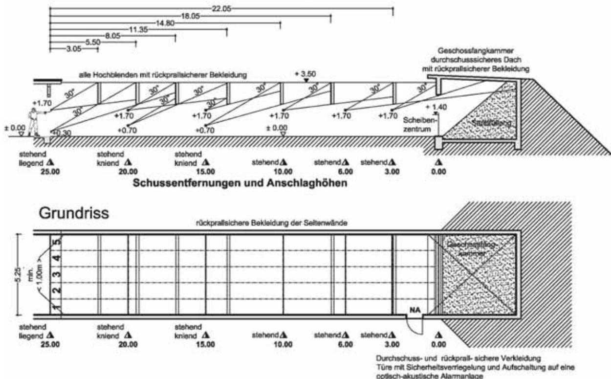
Abbildung 4.8.2 Blenden für das Schießen auf Zwischenentfernungen
