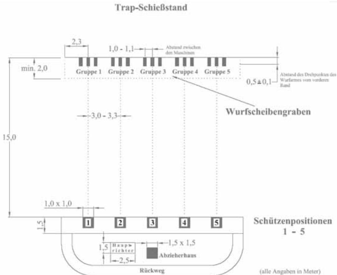
Abbildung 9.6.1.1.a Anordnung der Schützenstände beim sportlichen Trap-Schießen
