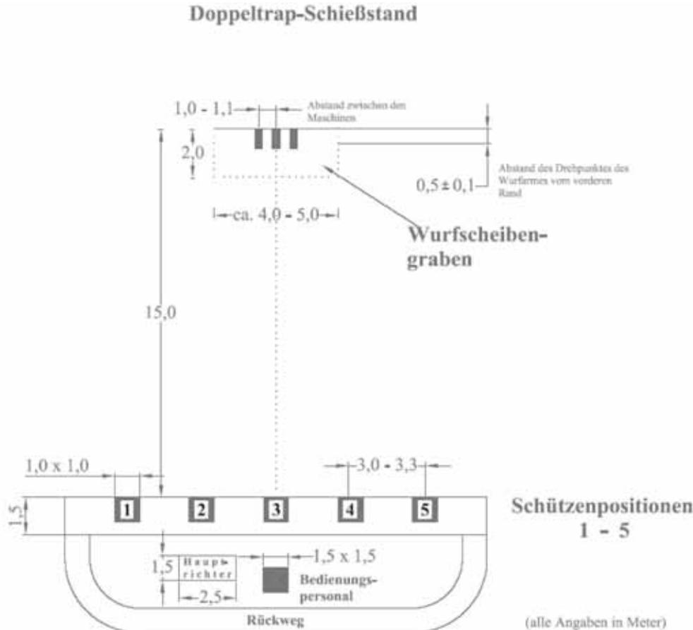
Abbildung 9.6.1.1.b Anordnung der Schützenstände beim sportlichen Doppeltrap-Schießen
