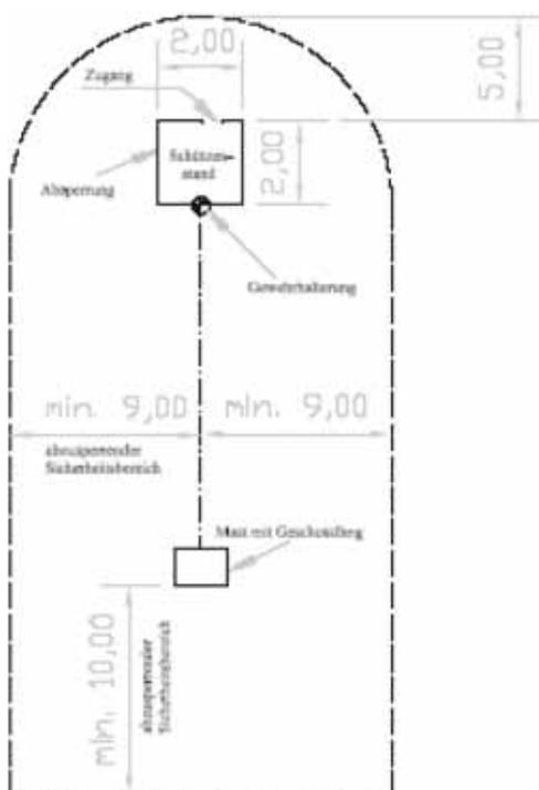
Abbildung 7.9.1 Sicherheitsbereich für Vogelschießstände
