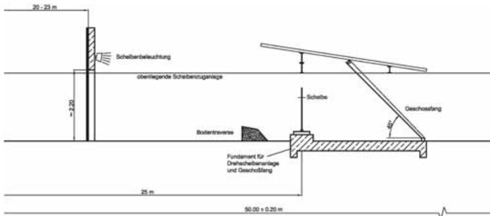
Abbildung 4.3.3 Nach unten ausschwenkbares Geschosssfangsystem
