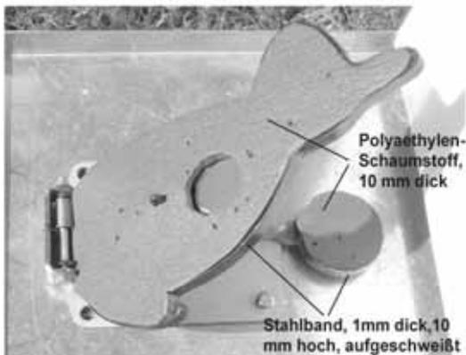
Abbildung 6.4.6.3 „Gepolstertes“ Field-Target-Silhouettenziel
