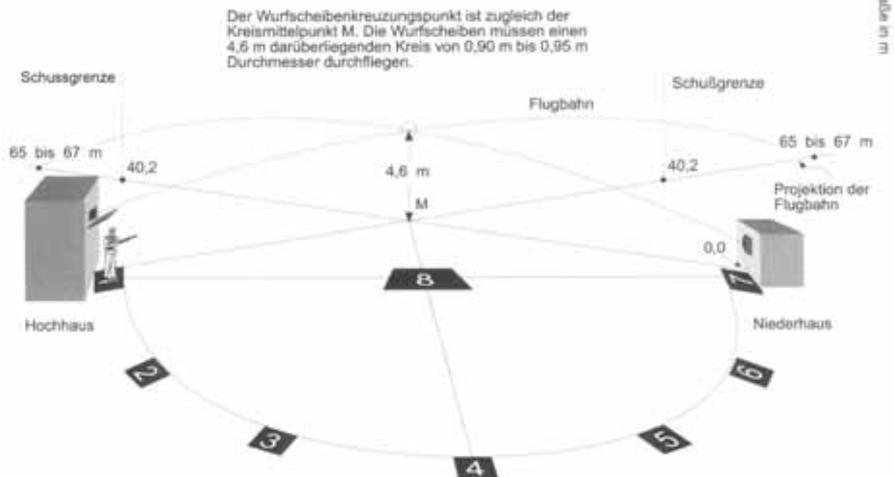
Abbildung 9.6.2.1 Wurfrichtungen und Flugweiten der Wurfscheiben beim Skeet-Schießen
