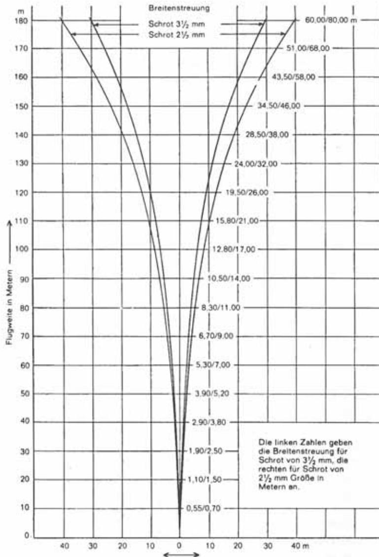
Abbildung 9.2.1.1 Durchmesser und Breitenstreuung von frei fliegenden Schrotkörnern
