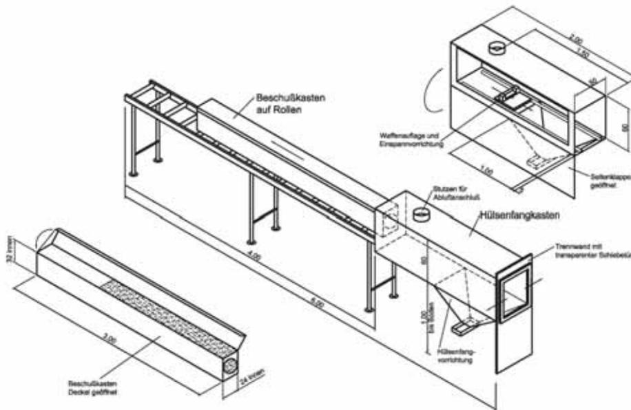
Abbildung 5.6.3.7.3 Wattebeschusskasten
