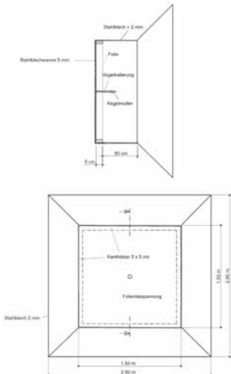
Abbildung 7.9.6 Geschosfang für Flinten mit Schrot auf Vogelschießständen
